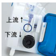
ポンプの上流／下流のフローチェック
